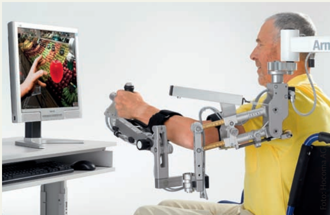
Abb. 4 Greifen, Rotieren, Loslassen – mithilfe des Roboters lassen sich alle Freiheitsgrade beüben.
