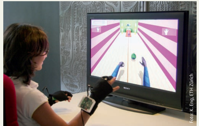
Abb. 5 Das PITS-System ermöglicht es, eine scheinbar korrekte Bewegung auszuführen, indem es das Bewegungsausmaß virtuell vergrößert.
